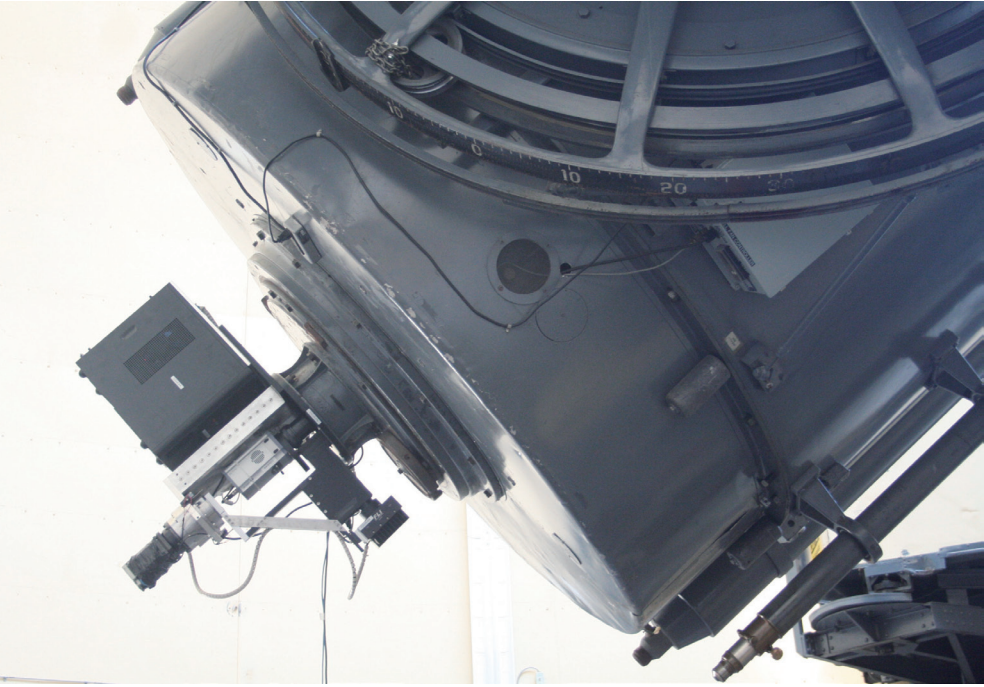
그림 6.2 서울대학교와 경희대학교가 공동 개발해 미국 맥도널드 천문대 2.1m 망원경에 장착한 근적외선 카메라 CQUEEN의 모습. 사진제공: 박수중 회원
