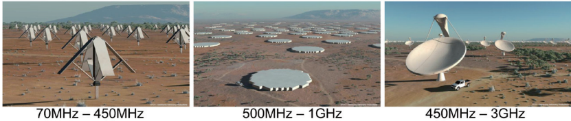
그림 5.19 SKA 안테나. 중심부에는 세 종류의 안테나 모두가 설치될 예정이고 주변부와 외곽부에는 접시형 안테나가 설치될 예정이다.(그림출처: SKA 웹사이트, http://www.skatelescope.org )
